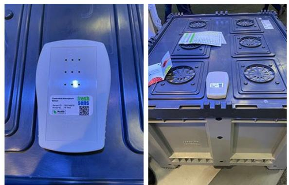
SST 社のセンサーは、酸素と二酸化炭素レベルを検出し、農作物の輸送で使用される保管箱の中に設置可能なほど非常に小さなセンサーとモジュールで構成され、共通して URAT 接続を持ち、同様の通信レジスタで動作します。
